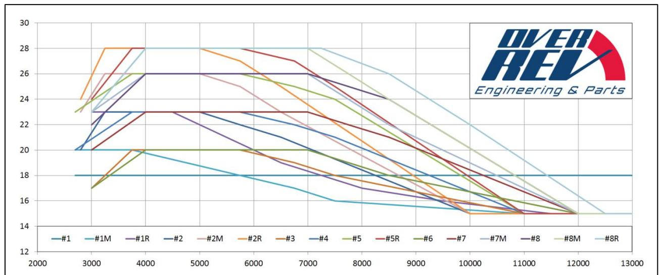
Abbildung 11 – Timing Curves of the „Overrev 2018“ ignition controll unit
