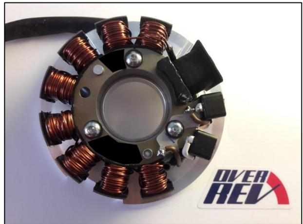
Abbildung 2 - Grundplatte mit montiertem Stator
