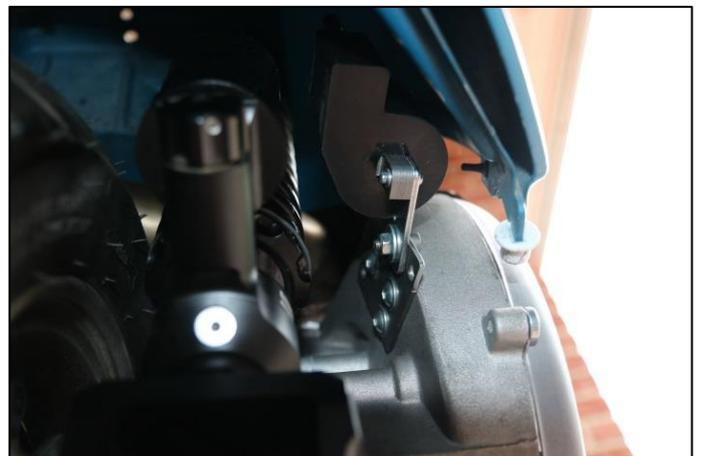
Abbildung 9 - Zündspule an originaler Position
