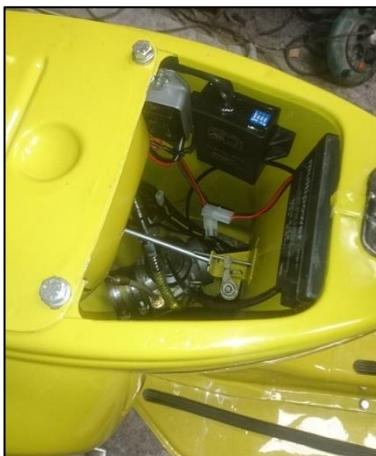
Abbildung 8 - CDI & Spannungsregler
